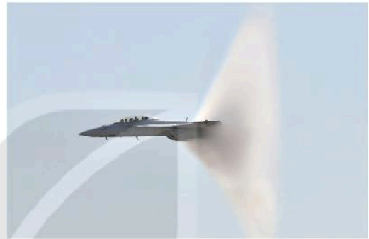
Ngoài nón Mach, khi bay với tốc độ siêu âm, máy bay còn tạo ra nón hơi nước mà ta có thể quan sát được.
